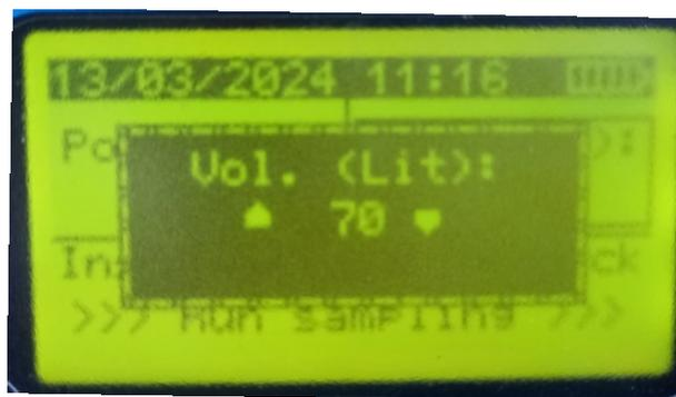
در این حالت کاربر می تواند توسط کلیدهای بالا و پایین و سپس OK، میزان حجم نمونه برداری شده را تغییر دهد و یا با فشردن کلید بازگشت، انصراف دهد. حجم نمونه برداری بصورت پیش فرض، ۷۰ لیتر تعیین می شود که نیاز به تغییر توسط کاربر نمی باشد. در دو صورت باید حجم نمونه برداری را تغییر داد:
