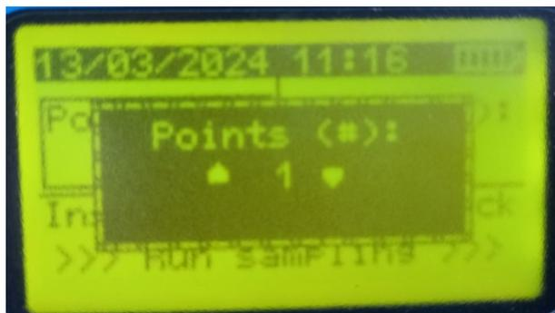
در این حالت کاربر می‌تواند توسط کلیدهای بالا و پایین و سپس OK، تعداد نقاط نمونه‌برداری را تعیین کرده و یا با فشردن کلید بازگشت، انصراف دهد. با افزایش تعداد نقاط نمونه‌برداری، کاربر می‌تواند در راستای قطر دودکش، در تعداد نقاط بیشتری با فاصله‌های مشخص از بدنه دودکش نمونه‌برداری انجام دهد که اینکار دقت محاسبه میزان غبار دودکش را افزایش می‌دهد (مطابق شکل زیر). تفاوت نمونه‌برداری در یک نقطه (پیش فرض) و تعداد نقاط بالاتر در این است که در حالت تک نقطه، کار
