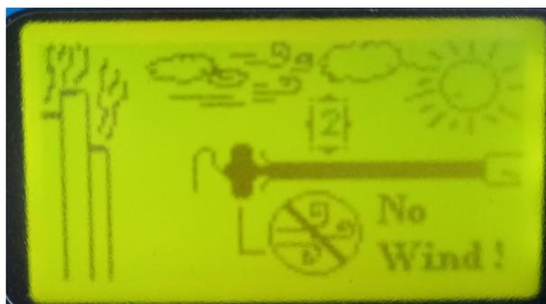
در این حالت کاربر همانطور که پراب را کاملاً بدون حرکت و ثابت نگه داشته بایستی حدود ۳ ثانیه تامل کند. اینکار بمنظور کالیبره پراب دستگاه در شرایط محیطی محل نمونه‌برداری بمنظور اندازه‌گیری هر چه دقیق‌تر سرعت دودکش صورت می‌گیرد و هر چه با دقت بالاتری انجام شود، دقت اندازه‌گیری سرعت سیال در داخل دودکش بیشتر خواهد بود. با اتمام زمان ۳ ثانیه، دستگاه بصورت خودکار وارد مرحله بعد می‌شود (در این مرحله کاربر می‌تواند پراب دستگاه را از حالت خود خارج کرده و در حالتی که راحت‌تر است نگه دارد):
