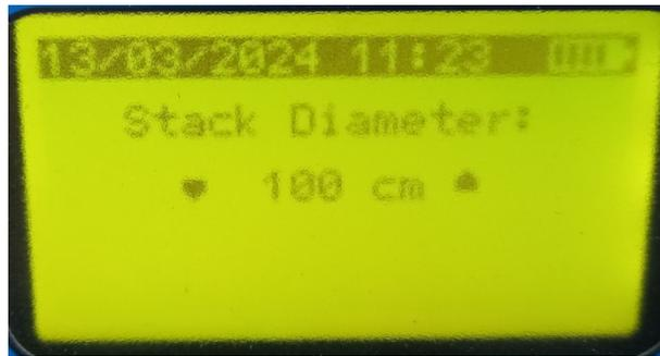
در این مرحله کاربر توسط کلیدهای بالا و پایین، میزان قطر دودکش مورد نمونه‌برداری را برای دستگاه تعیین می‌کند. با فشردن کلید OK، مراحل مختلف نمونه‌برداری به پایان رسیده و کاربر وارد صفحه ذخیره‌سازی و یا چاپ اطلاعات نمونه‌برداری انجام شده می‌شود (شکل زیر). در این مرحله، سه گزینه در اختیار کاربر قرار می‌گیرد:
